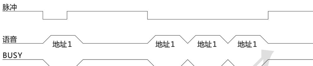
备注：负脉冲/低电平触发。当控制端口检测到下降沿时（如该控制端口对地短路25ms以上），播放一遍语音然后停止。当控制端口为低电平时，保持播放，播放过程中，就算是给高电平也不停止，直到语音播放结束。当第一遍结束后，如果还保持低电平，则会继续重复播放，只要不保持低电平且播放完当前语音后才停止。
