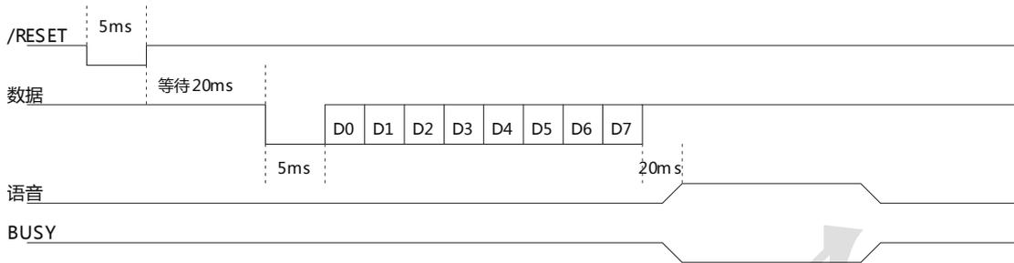
说明：/RESET为复位信号，发数据前对芯片进行复位，如不是在特殊的工业场合，可以不使用此复位信号。在每次发送数据前，不需要都发送复位信号，直接发送命令码或者地址数据即可。DATA为一线串口数据通信线，复位芯片稳定后先拉低5ms以唤醒芯片，低位在前，BUSY为语音芯片忙信号输出，数据成功发送后等待20ms，BUSY输出将作出响应。数据位占空比对应详见下图。
