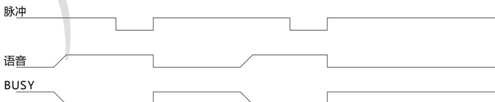
备注：负脉冲触发。控制端口检测到下降沿时（如该控制端口对地短路25ms以上）令正在播放的语音停止。语音停止后再次触发无效。
