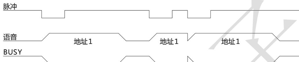
备注：负脉冲触发。当控制端口检测到有下降沿时（如该控制端口对地短路25ms以上），触发播放语音。在语音播放期间，再检测到下降沿，芯片会打断正在播放的语音，重新播放。只要有下降沿信号，就重新播放。
