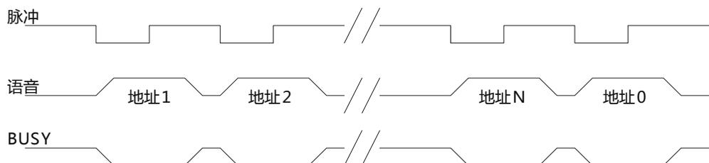
备注：负脉冲触发。控制端口检测到下降沿时（如该控制端口对地短路25ms以上）触发播放下一段语音，下一个下降沿继续触发播放下一段语音，重复操作，播放完最后一段语音，则会点播到第一段语音，如此循环触发播放语音。
