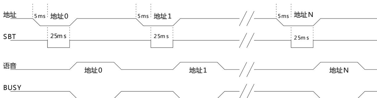
触发过程中，地址信号稳定时间为 5ms，发送地址 5ms 后才能发送 SBT 触发语音播放，SBT 触发保持时间 25ms。连续发送 SBT 时，要保证两个地址命令之间的间隔时间在 85ms 以上。
