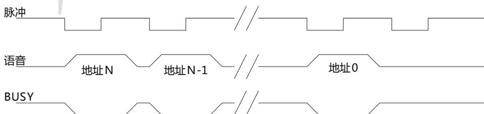
备注：负脉冲触发。控制端口检测到下降沿时（如该控制端口对地短路25ms以上）触发播放上一段语音，下一个下降沿继续触发播放上一段语音，播放完最前一段，则不再向前触发播放语音。
