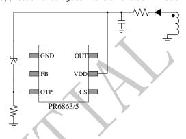
$$V_{\text{th\_OVP}} = V_{\text{zener}} + 4V$$
